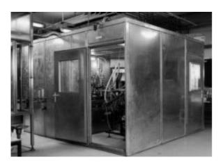
Produktbeschreibung Der Sonodamp entsprechend den Kundenwünschen gefertigtes schalldämmendes und -absorbierendes Gehäuse, kann in Stahl, Edelstahl oder Aluminium geliefert werden; ein Gehäuse wird aus schalldämmenden- und absorbierenden selbsttragenden Elementen zusammengestellt. Bei großen Gehäusen wird eine Stahlkonstruktion integriert.
